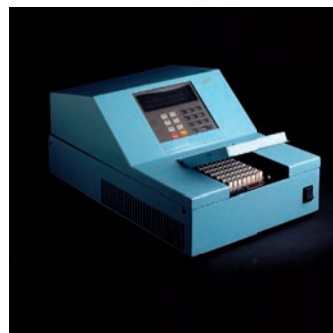
První prototyp termocykléru „Baby Blue“ z roku 1986, který zautomatizoval proces PCR. © John Cummings, CC BY-SA 2.0
