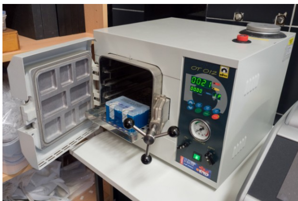
Obr. 12. Autokláv na sterilizaci laboratorného materiálu.
