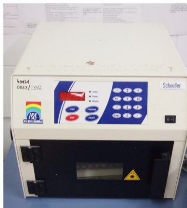
Obr. 13. UV crosslinker na sterilizaci spotřebního materiálu pod UV světlem.
