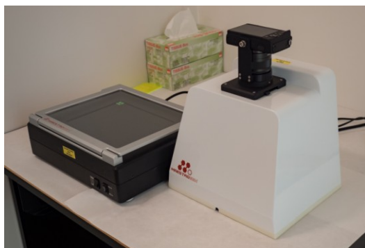
Obr. 9. UV transiluminátor (vlevo) s dokumentačním zařízením (vpravo).
