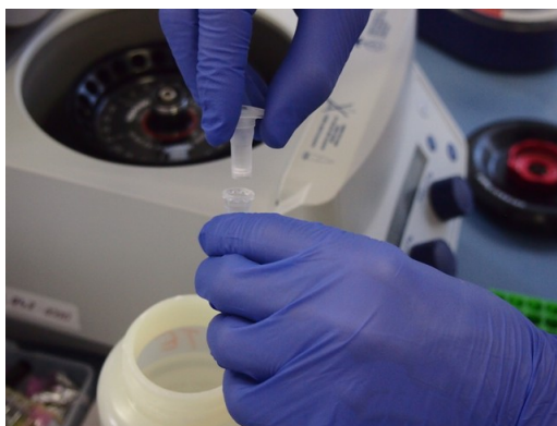
Obr. 27. Přenos kolonek do čistých zkumavek, ve kterých bude DNA uložena.
