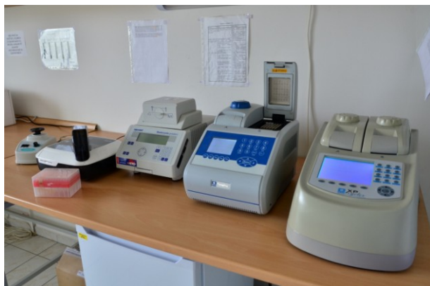
Obr. 28. Různé druhy termocyklerů od různých výrobců. Společným znakem je termoblok na 48 nebo 96 mikrozkušavek a počítač, který řídí změny teplot při PCR reakci.
