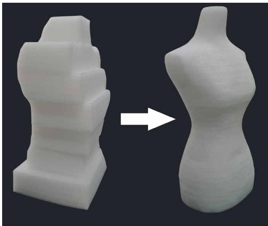
Obr. 3. Bloky pěny (vlevo) jsou postupně ořezávány do požadovaného tvaru (vpravo).
